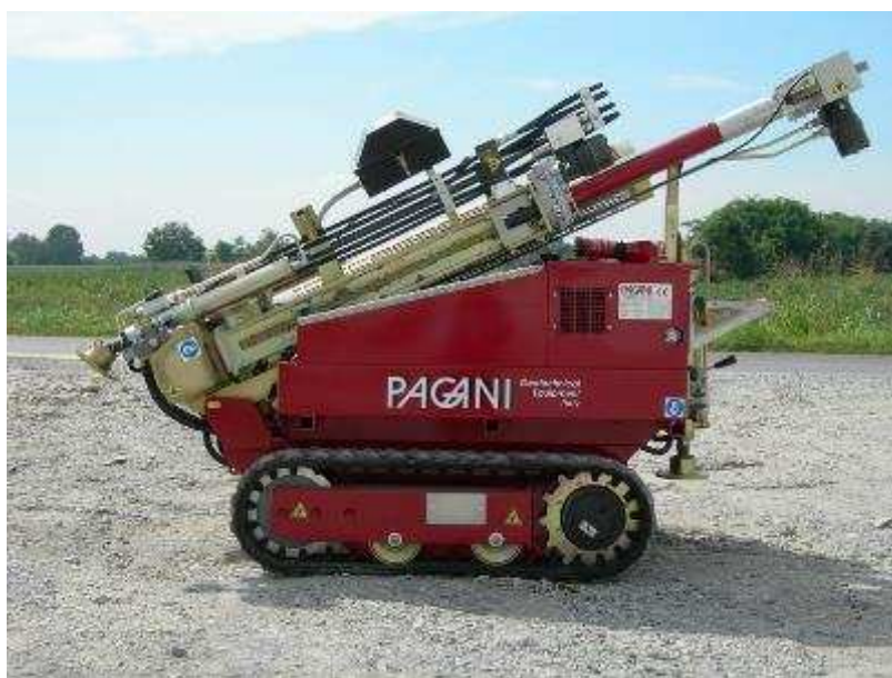
Slika 4: Dinamični penetrometer TG63-100
